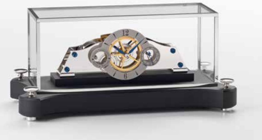
Malé stolní hodiny NT 5 „La mignonne“ se švýcarským kotvovým krokem o frekvenci 14 400 kyvů za hodinu, 14 kameny a délkou chodu 14 dní
